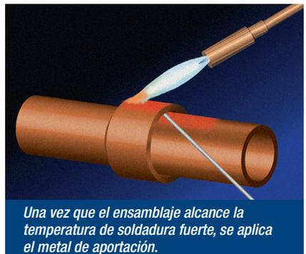
En ese punto, aleje un poco la llama y aplique el metal de aportación con firmeza contra el tubo, en la unión del tubo y el conector. Si usa una aleación que contiene fósforo, coloque la varilla sobre la unión y extiéndala a su alrededor, ya que estas aleaciones suelen fluir lentamente. Si la unión se calentó bien, el metal de aportación se fundirá, penetrará en la unión y la rellenará por completo.
