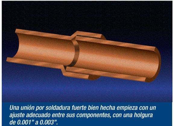
Sin embargo, debe tener cuidado con la preparación de los tubos para realizar la soldadura fuerte. Por ejemplo, si va a soldar un tubo a un conector, en general empezará cortando el tubo del largo que quiera. Asegúrese de que el corte sea en ángulo recto, utilizando una mordaza para serrar o un cortador de tubos, y quite las rebabas. Deslice el extremo del tubo en el interior del conector y revise que tenga el ajuste estrecho adecuado, un ajuste fácil de realizar por deslizamiento.
